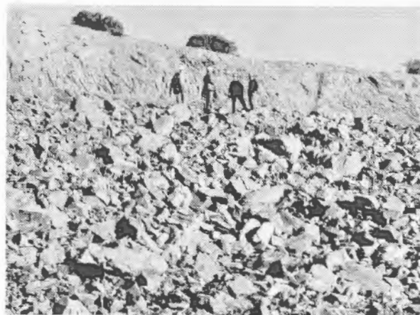
Foto 28.1. Aspecto general de la fragmentación obtenida en la voladura de un banco bajo de 6 m.
