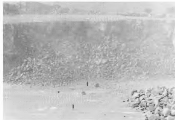
Foto 20.5. Resultado de una voladura de una fila en un banco de 20 m.
