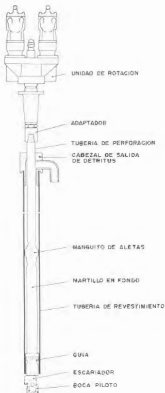
Figura 7.5. Método ODEX con martillo en fondo (Atlas Copco).
