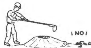
Figura 35.15. Evitar la introducción de piedras en el retacado.
