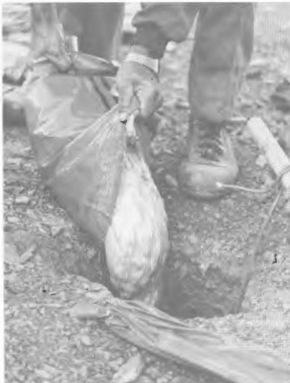
Foto 12.1. Empleo de hidrogel vertible en barrenos con agua.
