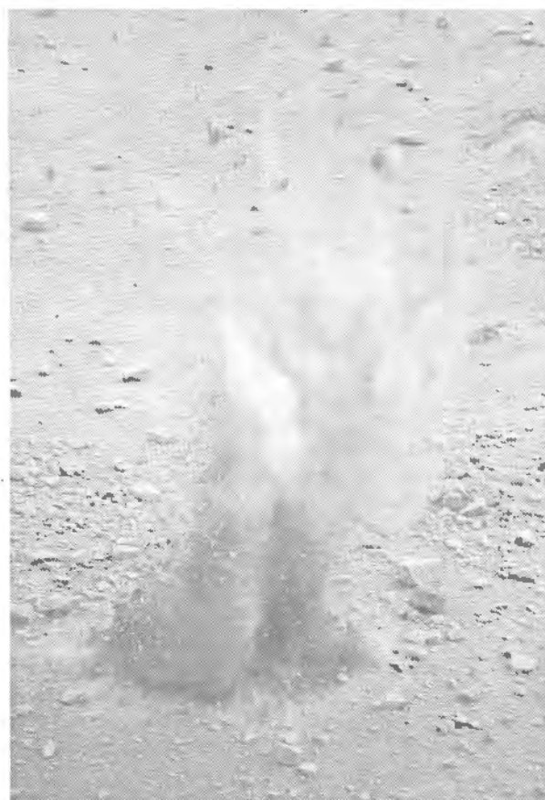
Foto 24.1. Prueba de voladura en cráter.
