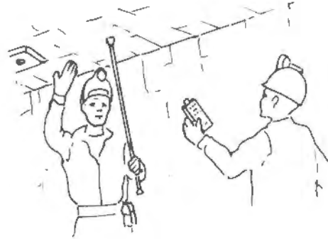
Figura 35.3. Comprobación del estado del techo y hastiales de las explotaciones.
