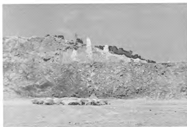
Foto 27.1. Voladura de una fila secuenciada en un banco de 20 m.
