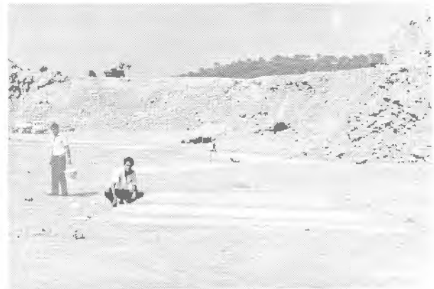
Foto 33.9. Pruebas en campo para medir la efectividad de reducción de ruido y onda aérea de una cubierta de arena sobre cordón detonante.
