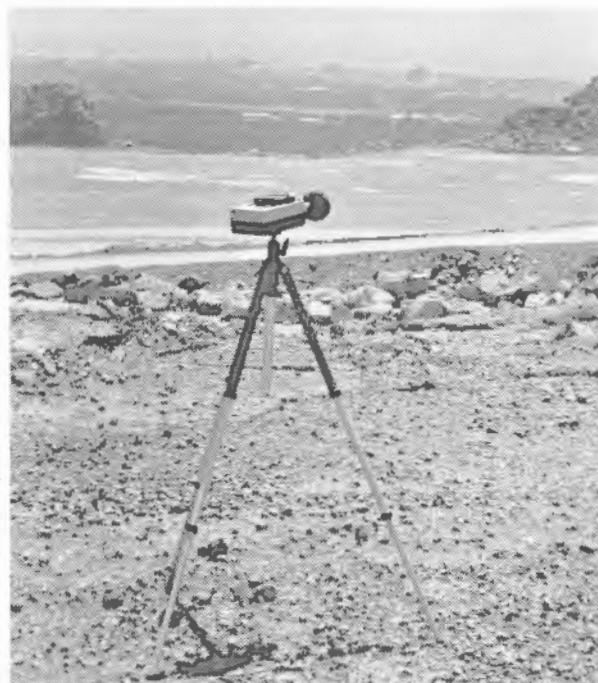
Foto 33.5. Instalación de sonómetro para medida de onda aérea.
