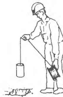
Figura 35.11. Introducción del cebo con cordón detonante dentro de los barrenos.
