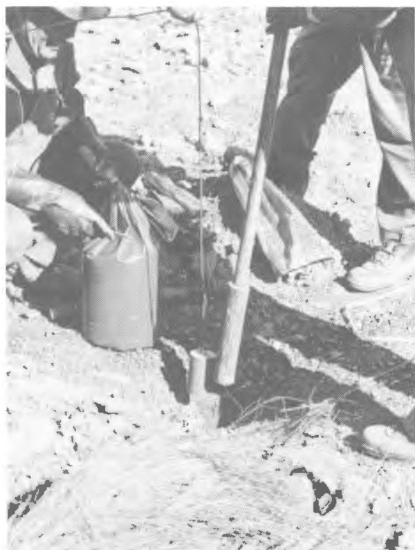
Foto 14.1. Colocación de un multiplicador para iniciar una columna de hidrogel vertible.
