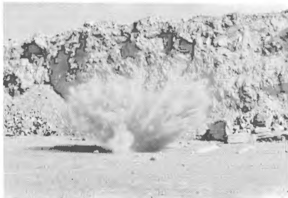
Foto 33.2. Efecto de un cordón detonante cubierto con arena.
