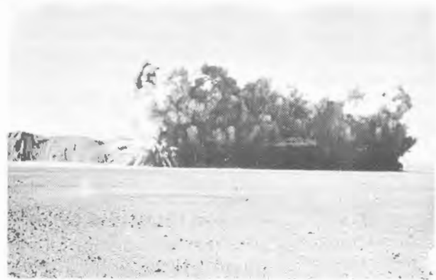
Foto 33.1. Alteraciones producidas por las voladuras, vibraciones, onda aérea, proyecciones y polvo.
