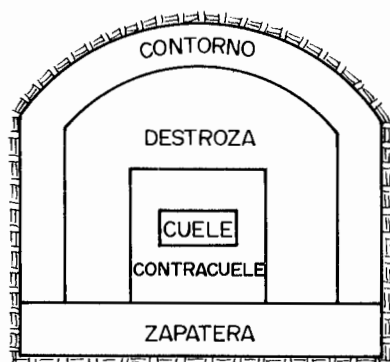
Figura 22.3. Zonas de una voladura en túnel.
