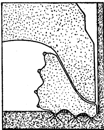
Figura 4.15. Rotura de la roca. Empuje excesivo.
