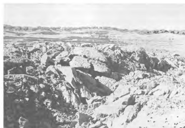
Foto 28.5. Bolos en la parte alta de una pila de material.
