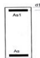
Fig. 5.2.4.: Sección viga con doble armadura. Fuente: "Manual de cálculo de estructuras de hormigón armado" Ing. Pozzi Azzaro.
