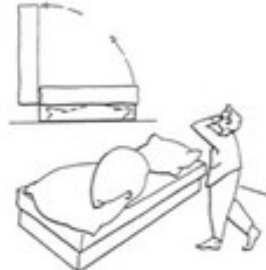
6 Igual que el ejemplo anterior con un cajón debajo del colchón para guardar la ropa de cama durante el día
