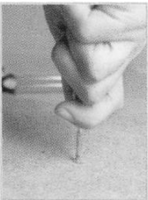
1 Con una lezna, se presiona un poco la madera.
