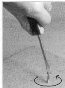
3 Si el giro se realiza en el sentido contrario al de las agujas del reloj, se extrae el tornillo y la unión se libera.
