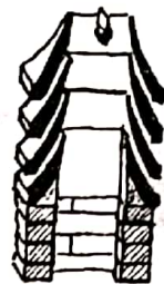
• colector de ventilación SPIRO de mortero de cemento
