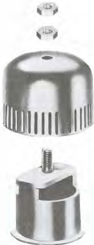
Fig. 2-2 Capuchón desmontado. El tubo ascendente que se muestra en la parte baja de la fotografía se sujeta al plato. El gas fluye a través del tubo y llega al capuchón de donde sale por las rejillas verticales, dispersándose en la fase líquida que cubre las rejillas del capuchón. (Vulcan Mfg. Co.)
