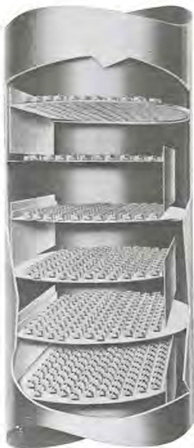
Fig. 2-8 Corte de una columna con platos de válvula para flujo cruzado. (Cortesía de Glitsch, Inc.)
