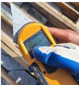
Figura N°6. Susceptibilímetro colocado sobre testigo cortado.
