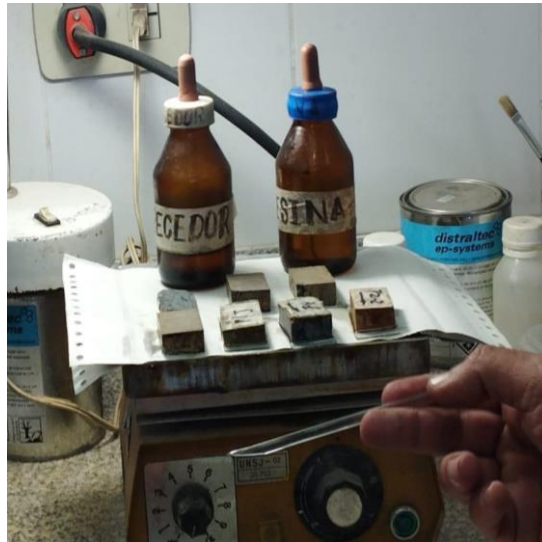
Figura N 9: Plancha termostática para atemperar cortes y vidrios.
