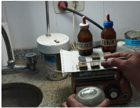
Figura N 18: Colocación de resina epoxi en la pastilla
