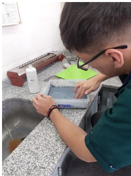
Figura Nº 5 Desbaste de pastillas con abrasivo.
