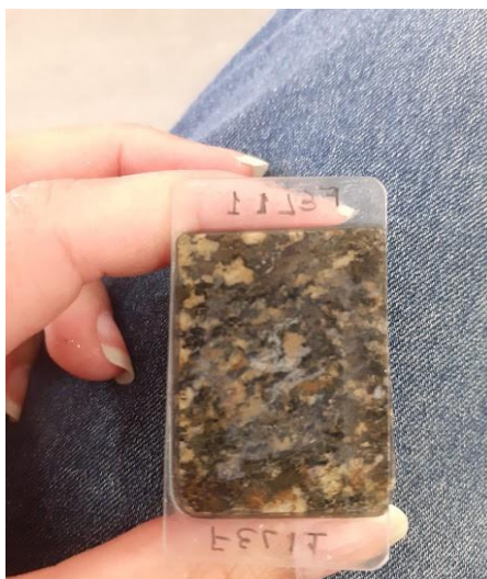
Figura N° 7: Pastilla secada y pegada al portaobjeto.
