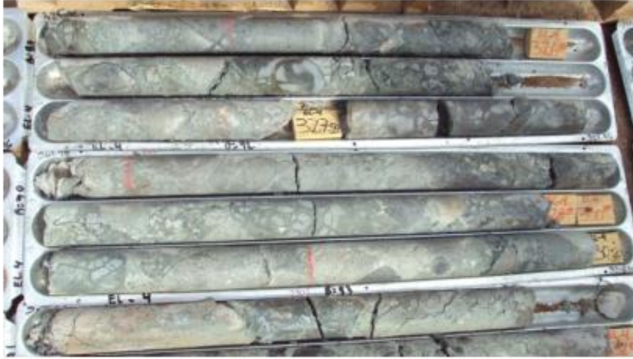
Foto 3.3: Brecha de falla con matriz arcillosa y granos subangulares.
