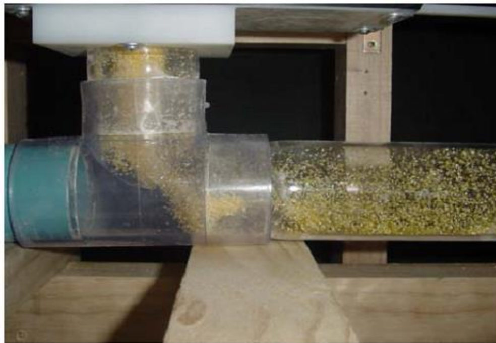
Figura 5: Ensayos con griz de maíz: Punto de alimentación de material a alta velocidad y sin acumulación.
