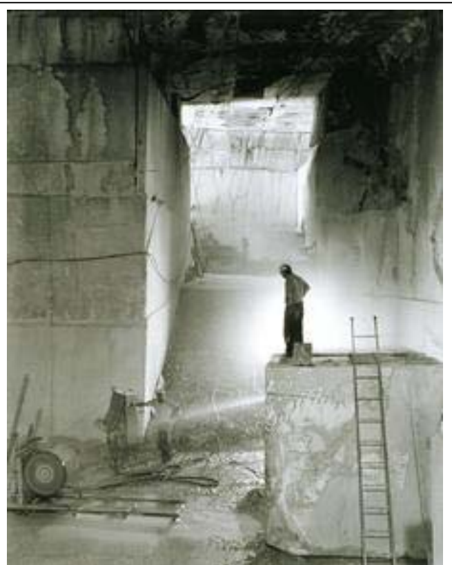
Aplicación del corte con hilo diamantado en una cantera subterránea de mármol en Carrara, Italia.
