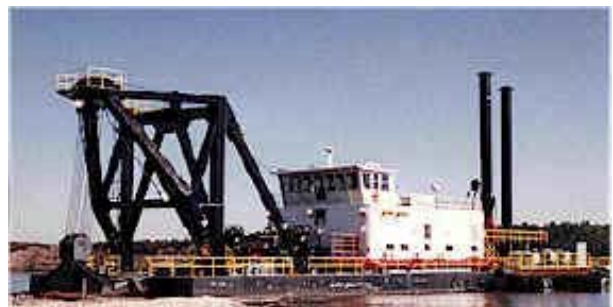
Draga de gran envergadura diseñada para la extracción de arenas de TiO_2 en Florida, EE.UU. Propiedad: Corporación DuPont (Cortesía Ellicott International).
