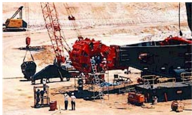
Construcción y montaje de la draga bautizada como "Cooljarloo I", para la extracción de arenas con minerales pesados en Australia Occidental. Es la draga más grande existente en Australia.
