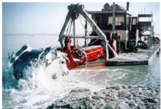
Draga Ellicott B890 Bucketwheel Dredge para extracción de sales, propiedad de Xingjiang Salt Lake Chemical, China (Cortesía Ellicott International).
