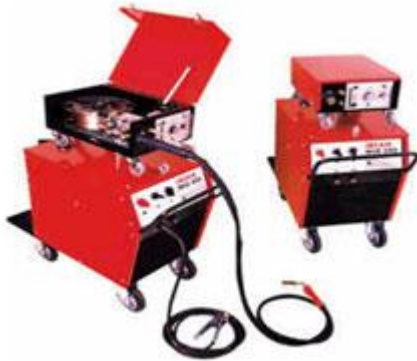
Figura 13. Grupos de soldadura eléctrica por arco tipo MIG
