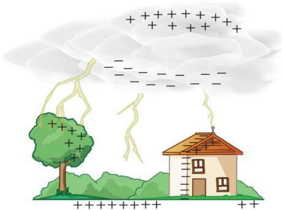
Figura 3.88 Un pararrayos proporciona una trayectoria de la carga eléctrica hacia la tierra para evitar daños.
