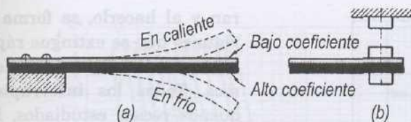
Figura N° 3.20 Esquema de principio de un elemento bimetálico
