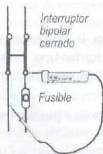
Figura N° 12.08 Verificación del interruptor
