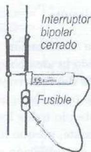
Figura N° 12.09 Verificación de los fusibles
