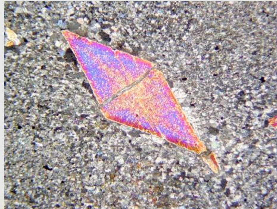
Cristales automorfos de escapolita en un mármol. Polarizadores cruzados.
