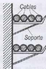
Figura N° 5.10 Soporte para varios cables
