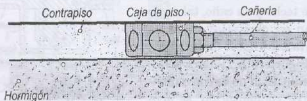
Figura N° 5.24 Detalle de la colocación de un caño en el piso
