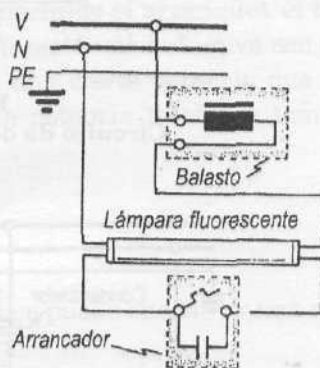
Figura N° 9.20 Circuito de una lámpara fluorescente
