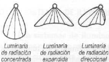
Figura N° 9.03 Distribución luminosa de las distintas luminarias
