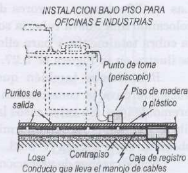
Figura Nº 5.25 Instalación bajo piso
