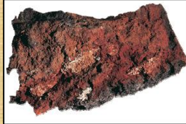
Hematita ( \text{Fe}_2\text{O}_3 ), óxido férrico, contiene hasta un 70% de Fe. Se presenta en masas terrosas de color rojo
