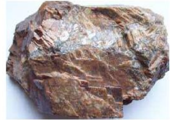
Siderita ( \text{CO}_3\text{Fe} ), carbonato ferroso, 48% de Fe, de color blanco.
