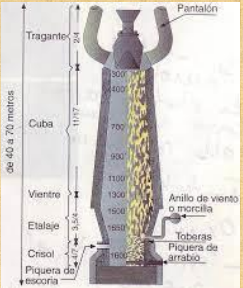
Figura 5.7. Partes, medidas y temperaturas aproximadas de un horno alto.
