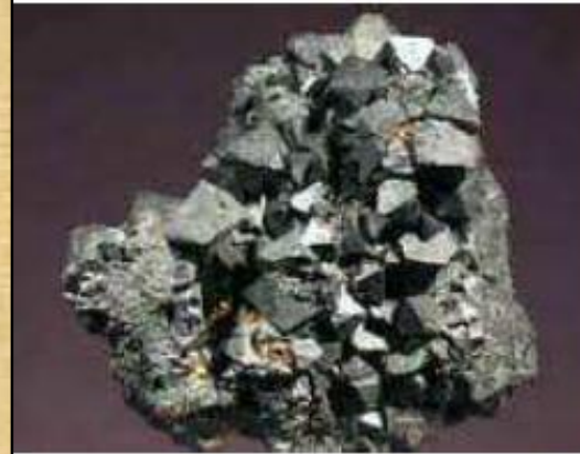
Magnetita ( \text{Fe}_3\text{O}_4 ), óxido magnético, 70% de Fe, se lo llama piedra imán.
