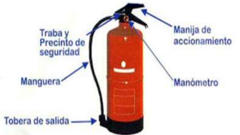
Figura 10 – Partes del extintor
