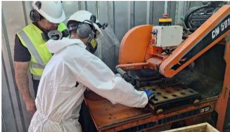
Figura 17 Corte de testigo maquina manual
