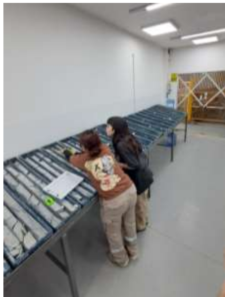
Figura 11. Tomando la Geotecnia de los testigos
