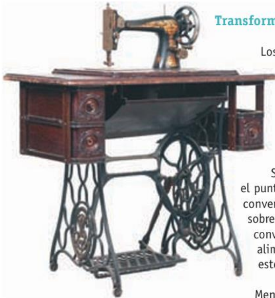
Figura 3.28. Estas antiguas máquinas funcionaban mediante la energía mecánica que proporcionaban los pies y un pedal.
