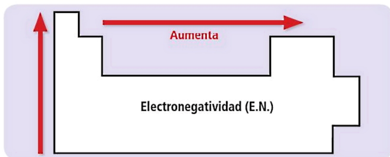
FIGURA 2.23. Representación esquemática de la tabla periódica donde se muestra el crecimiento de la electronegatividad a lo largo de grupos y periodos. Notar que el crecimiento en los periodos incluye solo un par de gases nobles.
