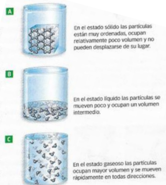
Fig. 1-6. El esquema representa las partículas (moléculas) de agua en los estados sólido (A), líquido (B) y gaseoso (C), como ejemplo de lo que ocurre con todas las sustancias.
