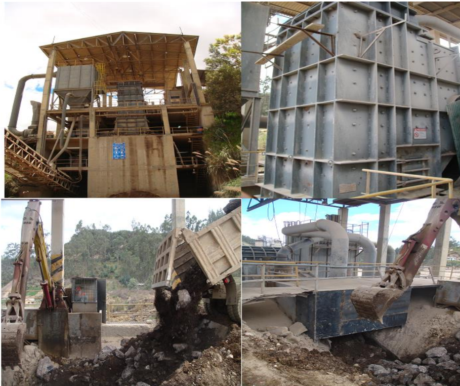
Figura 2.1. Imágenes de Triturador de Martillos marca Williams Patente Crusher&Pulv. Co. Fuente: Propia
