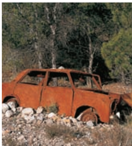
Figura 8. La combinación del hierro y el oxígeno forma el óxido de hierro (herrumbre).
