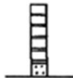
3) Muro sin cimiento
