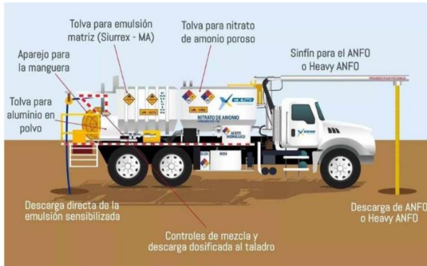
Figura 5: Imagen de camión fabrica y sus partes principales
