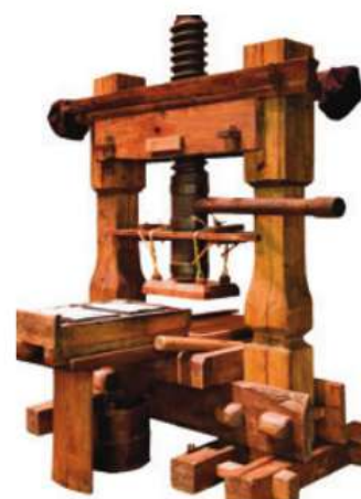
▲ Imprenta creada por Johannes Gutenberg hacia 1440. Funcionaba con letras móviles talladas en madera o metal.
