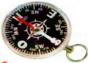
La brújula es un instrumento que tiene una aguja imantada que señala el Norte sobre el dibujo de la rosa de los vientos.
