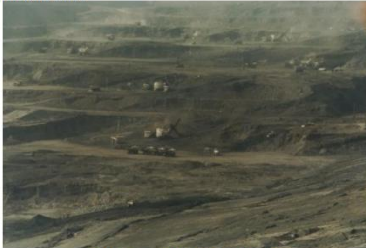
FIGURA 1. Explotación por bancos
