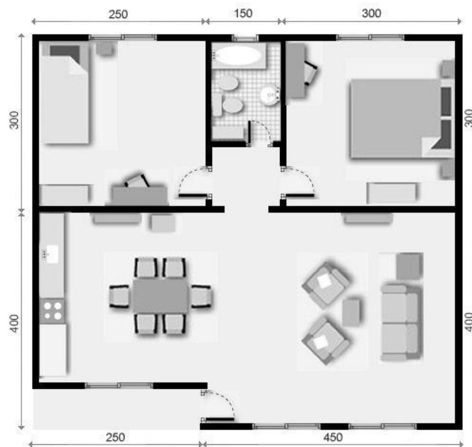
Ilustración 1 - Plano de una casa. Quien hizo este plano tuvo que usar una escala para mantener la dimensión de los muebles. De otro modo, si no conserváramos la escala, no tendríamos real dimensión del espacio dentro de la casa.
