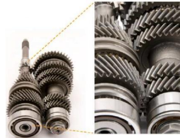
Engranajes de dientes helicoidales: en vez de tener dientes rectos, los tiene curvados. El engranaje es mucho más silencioso.
