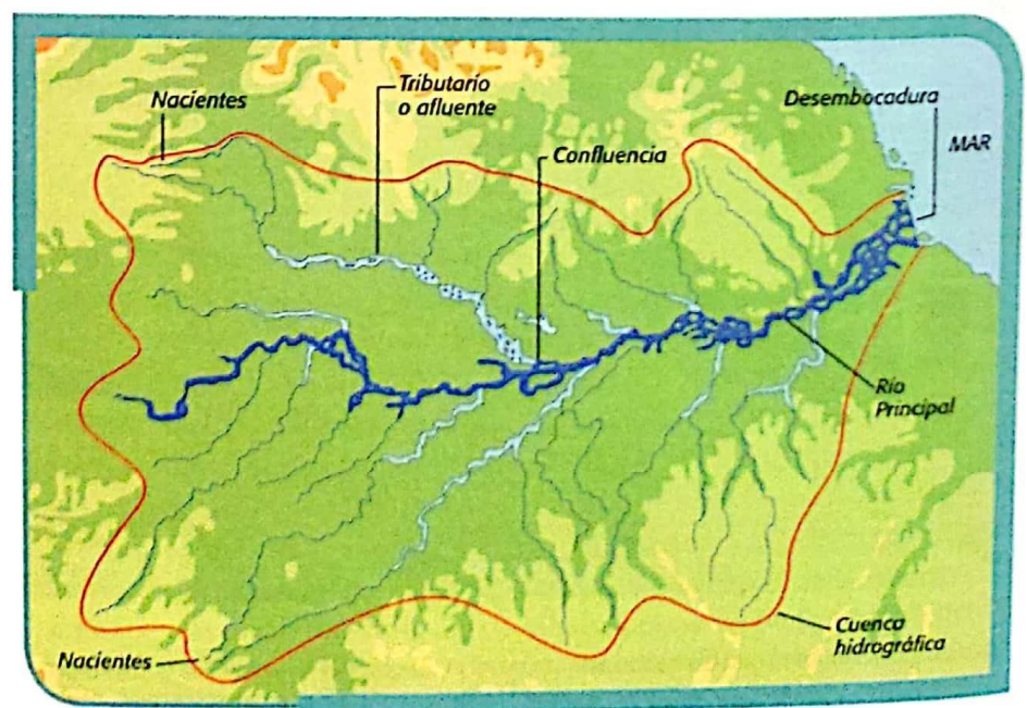
Esquema de una cuenca hidrográfica. Toda el agua precipitada se escurre por la superficie hacia los ríos, y desde allí hacia las zonas más bajas.
