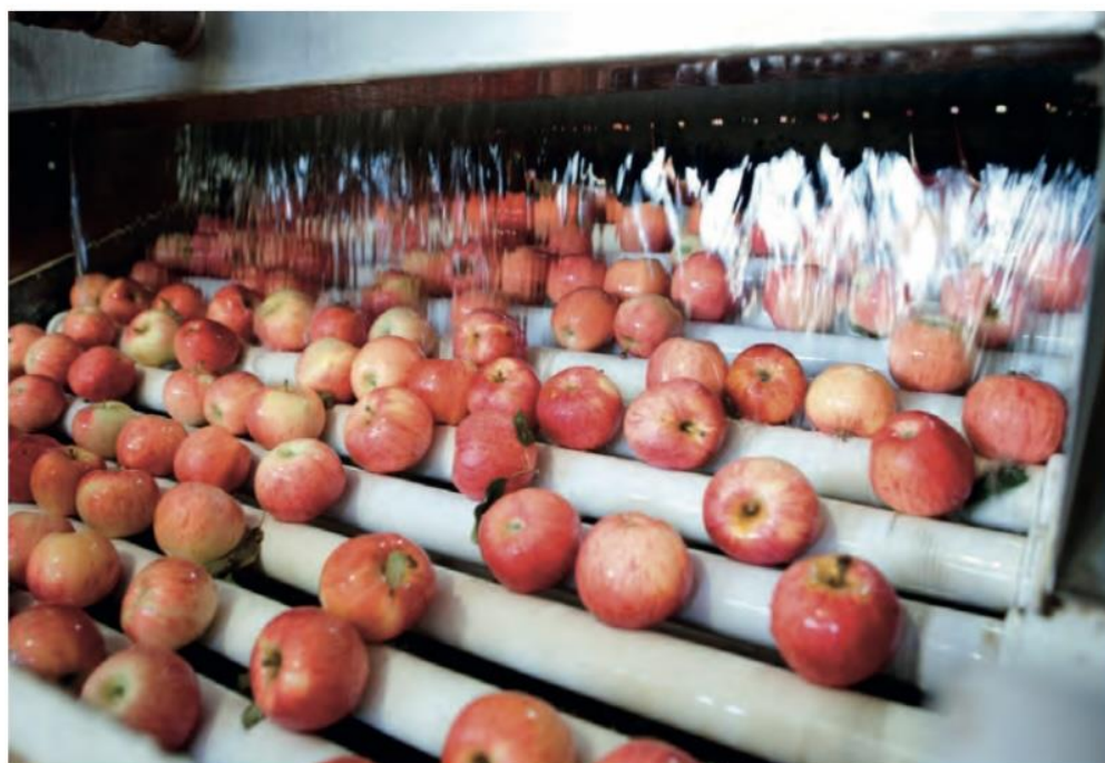
Etapa de selección y lavado de las manzanas en el Alto Valle del río Negro, para su posterior empaque, refrigeración y envío a los centros urbanos, para su comercialización.
