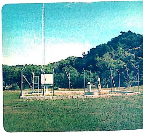
En las estaciones meteorológicas se miden la temperatura, la presión, la caída de lluvia o nieve y la velocidad y dirección del viento.
